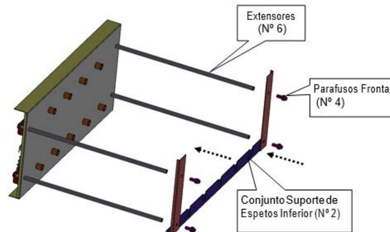
**Passo 03:** Montar os extensores (Nº 6) no Conjunto Mecânico Posterior (Nº 1) através dos Parafusos Posterior (Nº 5).
