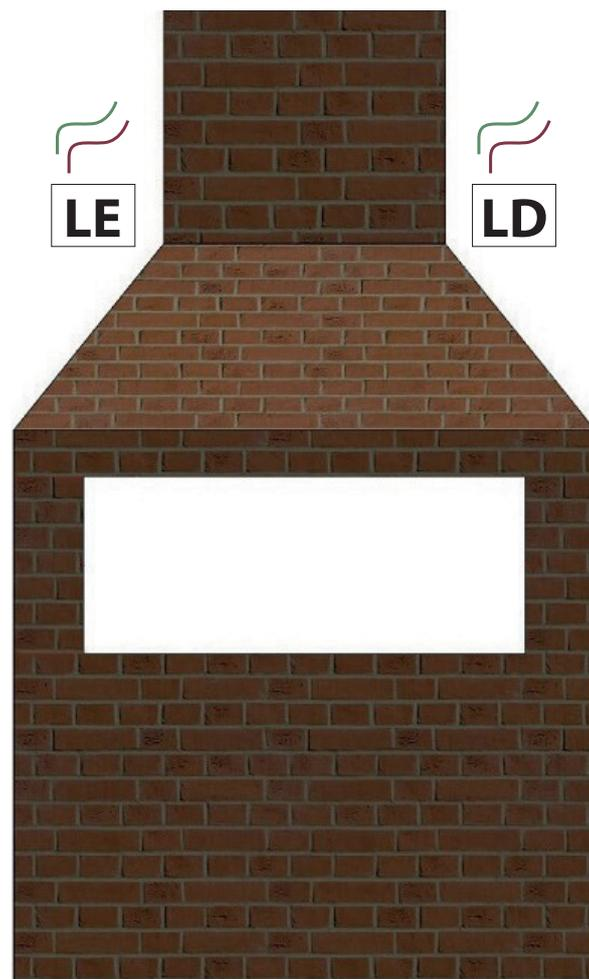
Para uma melhor instalação, indique o lado mais próximo da rede elétrica para poder instalar o sistema elétrico da churrasqueira.
